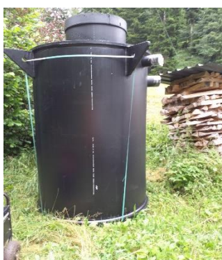
Normschacht aus korrosionsbeständigem Polyethylen
