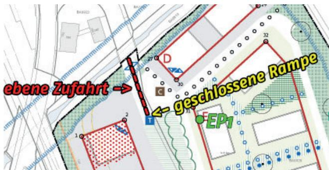
Die Tiefgarage hat eine Zufahrt auf die Parzelle Kat. Nr. BA7285. Die Zufahrt besteht l armtechnisch aus einer «ebenen Zufahrt» (Parzellengrenze bis Beginn  berdeckung) und einer «geschlossenen Rampe» (ab Beginn  berdeckung).
