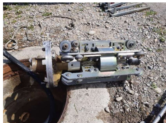
Abbildung 25: links die sichtbare Kalkablagerung in der Leitung, rechts angewandte Fräse
